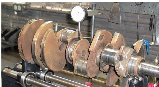
Fig.3.7. Verificarea coaxialitatii fusurilor palier, a incovoierii axei arborelui si a uzurii fusurilor
